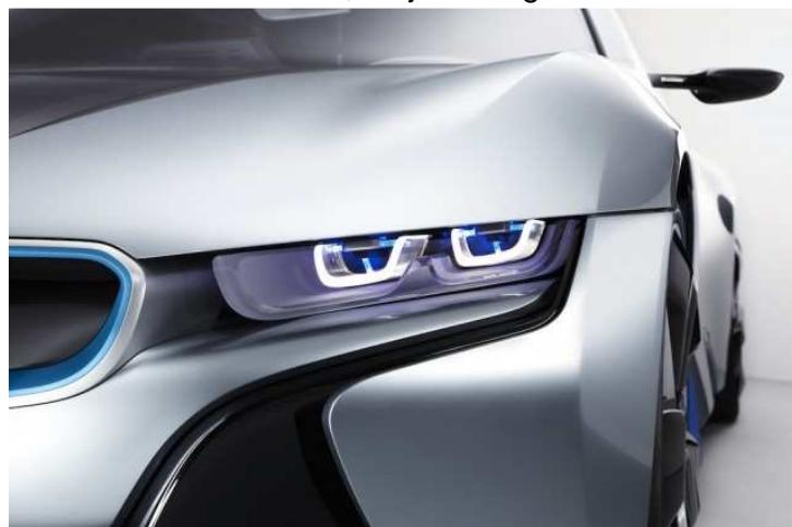
U ova dva segmenta prednje svetiljke su migavac, poziciono svetlo, dnevno svetlo, kratko svetlo, dugo svetlo i svetlo za maglu. Umesto pet ili šest svetiljki na ovom BMW-u su samo dve elegantno postavljene i jako dobro zaštićene od udara.
