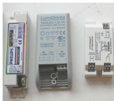
Slika 2. Električno kolo LED svetiljke i neki drajveri renomiranih proizvođača
