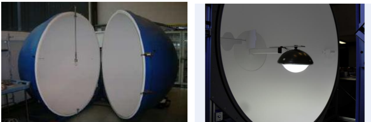
Slika 4. Integraciona (Ulbrichtova) sfera [3,4]
